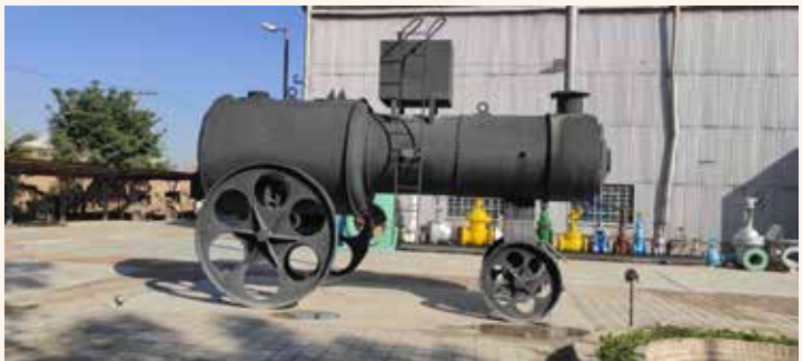
دستگاه تولید کننده بخار سیار برای مصارف خاص، موزه کارآموزان آبادان.
