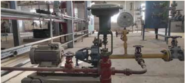
نمونه‌هایی از دستگاه‌های ابزار دقیق شیر کنترل جریان و نشان دهنده مقدار جریان مواد نفتی. موزه کاراموزان آبادان.
